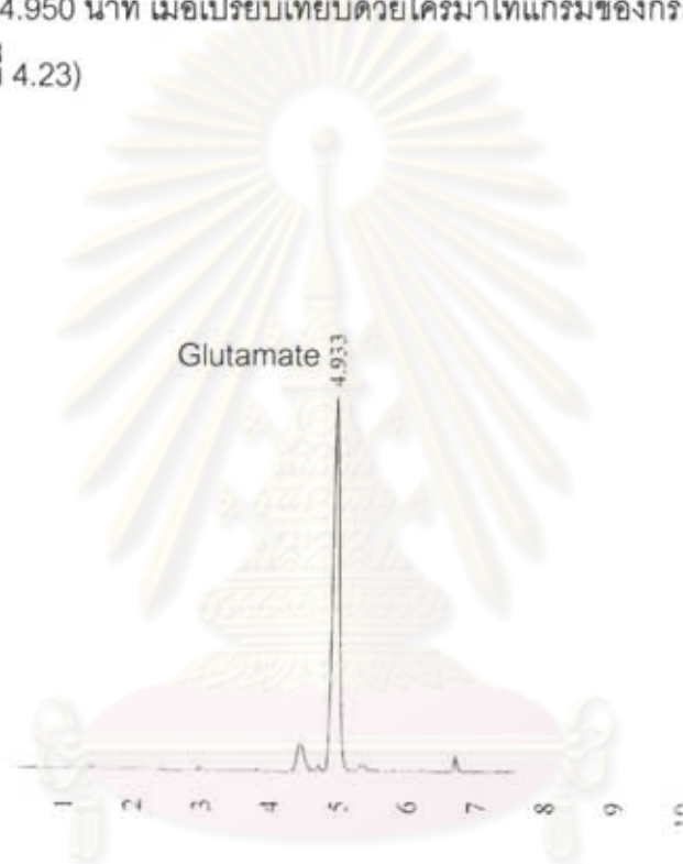
รูปที่ 4.22 โครมาโทแกรมของ HPLC จากไบโอพอลิเมอร์บริสุทธิ์ที่ผ่านการย่อยด้วยกรดไฮโดรคลอริก
