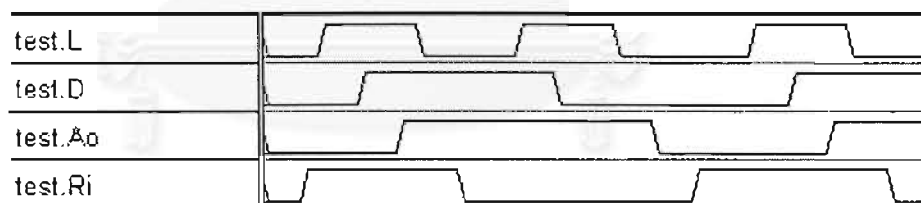
รูปที่ 3.7 การจำลองพฤติกรรมของวงจรร้อยของวงจrfifo สำหรับสัญญาณL ด้วยเวกเตอร์ทดสอบที่1
