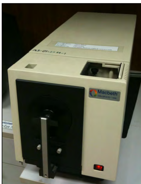
รูปที่ 3.7 เครื่องวัดสี (Reflectance Spectrophotometer) ของ Macbeth (รุ่น COLOR-EYE 7000)
