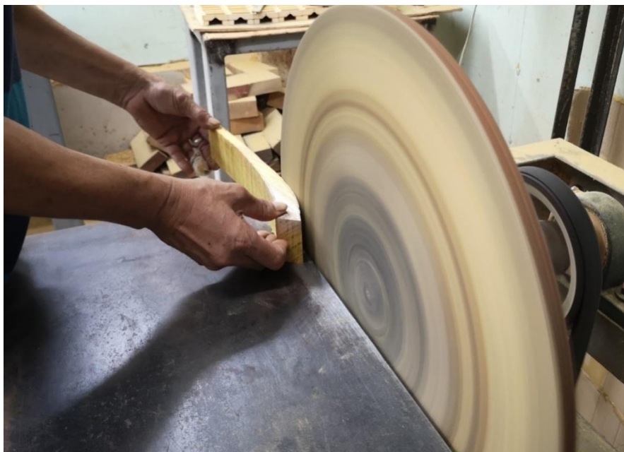
ภาพที่ 178 การใช้เครื่องกระดาษทรายงานขัดเก็บรายละเอียดส่วนของโคนด้านข้าง ที่มาภาพ : วิศรุต แซ่จ๋อง
