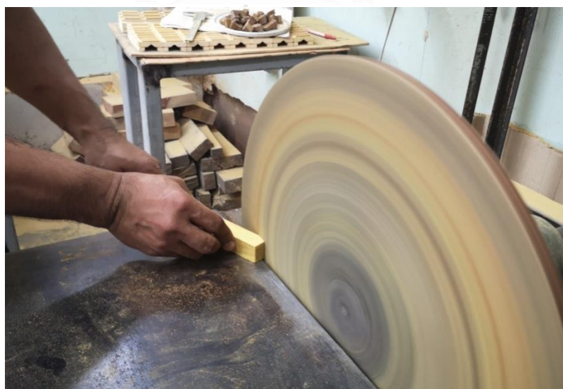
ภาพที่ 160 การใช้เครื่องกระดาษทรายงานขัดตกแต่งแกนกลางของคันทวน
