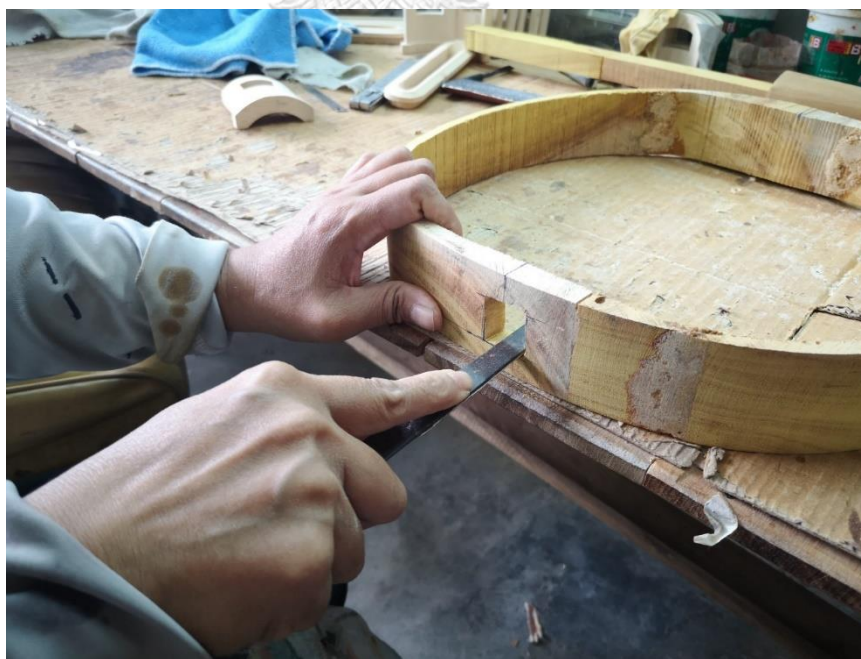
ภาพที่ 158 การใช้ตะไบกระดาศทรายขัดตกแต่งรูต่อแกนคันทวน ที่มาภาพ : วิศรุต แซ่จูง
