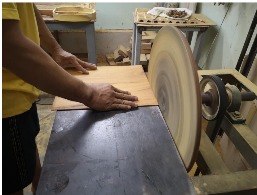
ภาพที่ 169 การใช้เครื่องกระดาษทรายจานเก็บรายละเอียดของขอบแผ่นไม้ทั้ง 4 ด้าน ที่มาภาพ : วิศรุต แซ่จ๋อง
