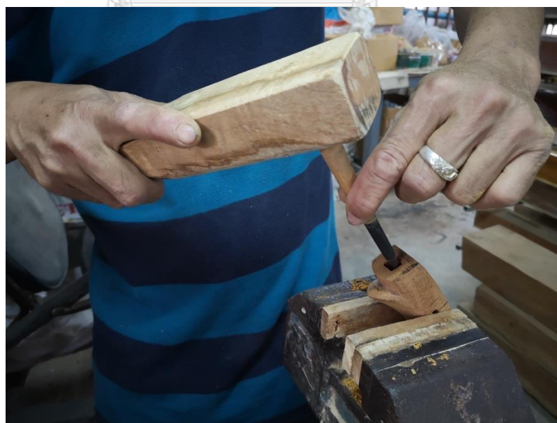
ภาพที่ 138 การใช้ส่วเซาะเนื้อไม้จากรวงกลมเป็นรูสี่เหลี่ยม ที่มาภาพ : วิศรุต แซ่จูง
