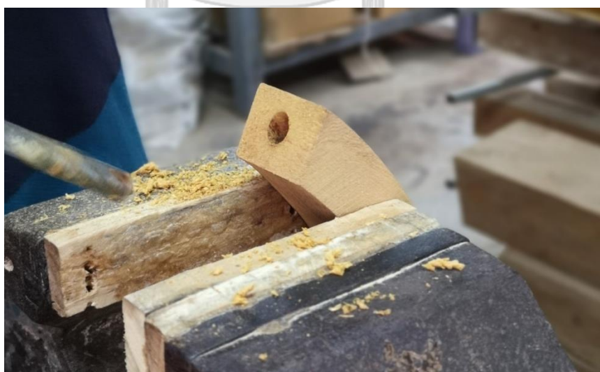
ภาพที่ 185 การใช้สว่านไฟฟ้าแบบพกพามาเจาะรูตรงกลางด้านล่างของโขน
