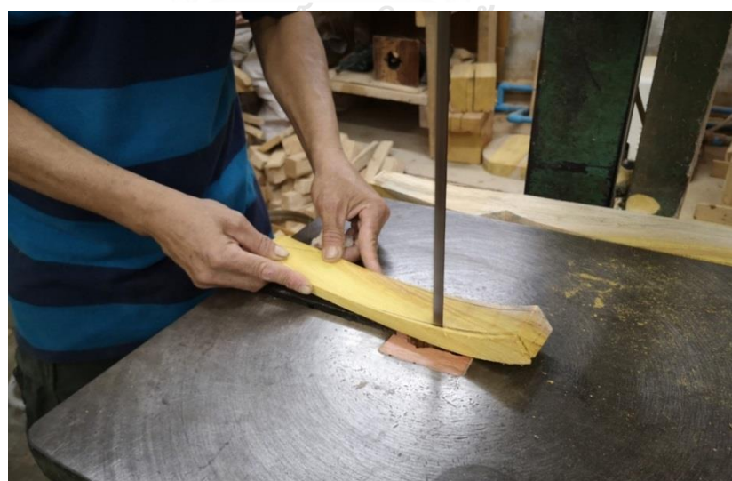
ภาพที่ 181 การใช้ใบเลื่อยไฟฟ้าเลื่อยตามแบบโขนด้านหน้า
