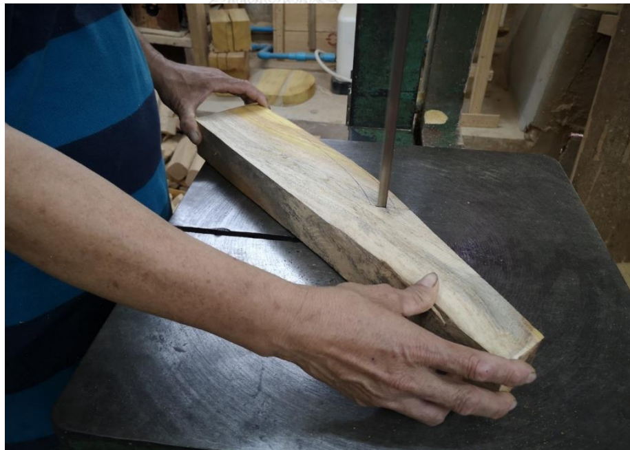
ภาพที่ 177 การใช้ใบเลื่อยไฟฟ้าเลื่อยตามแบบของโหนด้านข้าง ที่มาภาพ : วิศรุต แซ่จ๋อง
