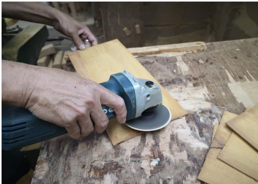
ภาพที่ 167 การใช้เครื่องเจียนลูกหมูขัดตกแต่งแผ่นไม้ ที่มาภาพ : วิศรุต แซ่จูง
