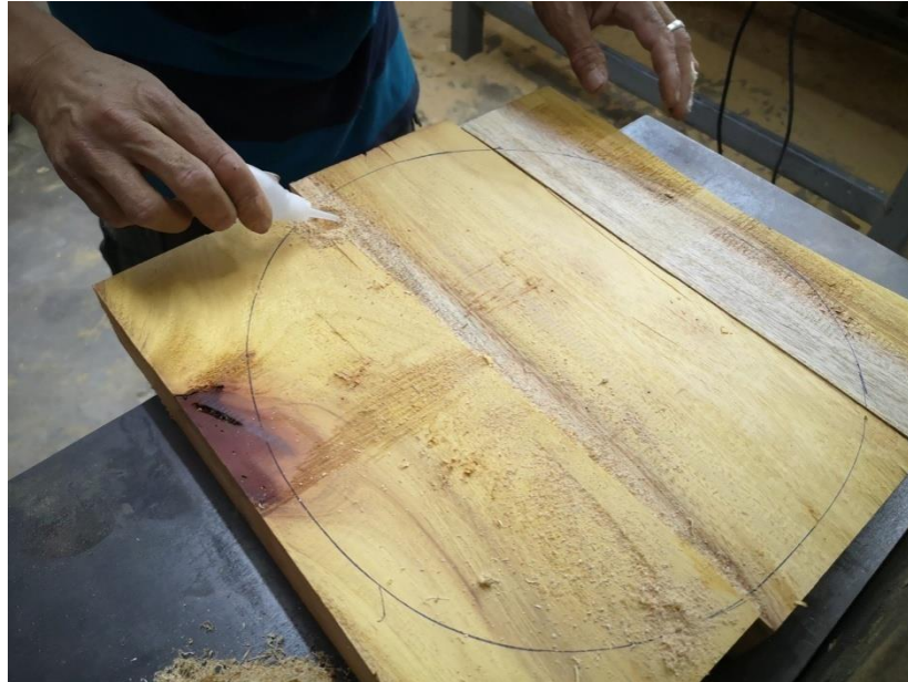
ภาพที่ 143 การนำซี่เลื่อยโรยแล้วใช้กาวยร้อนหยอดประสานให้ไม้ 3 ท่อนติดกัน ที่มาภาพ : วิศรุต แซ่จูง
