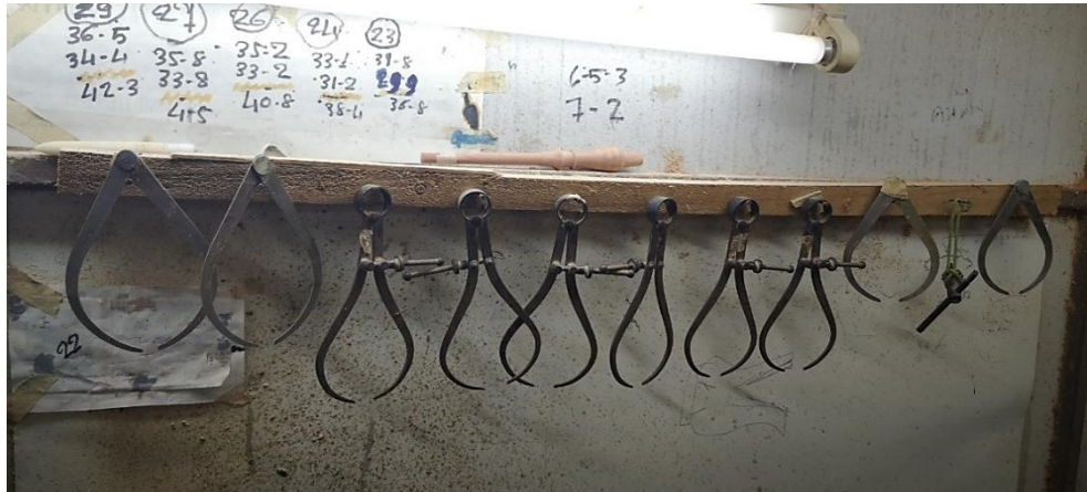
ภาพที่ 61 คาลิปเปอร์วัดนอก (เขาควย) ขนาดต่าง ๆ
