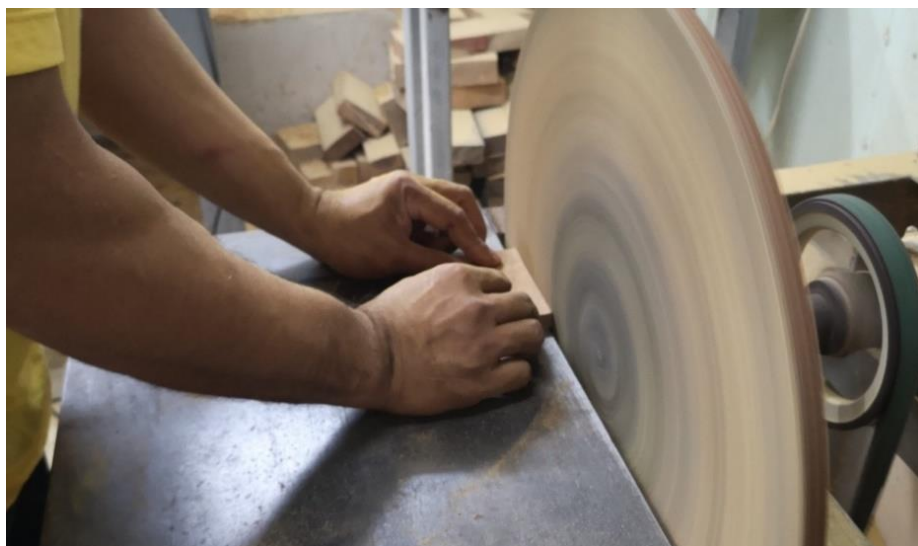
ภาพที่ 201 การนำชิ้นไม้มาขัดเก็บรายละเอียดด้วยเครื่องตาสทรายจาน ที่มาภาพ : วิศรุต แซ่จูง
