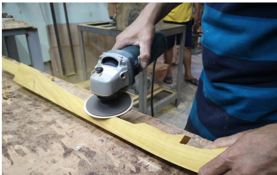
ภาพที่ 123 การใช้เครื่องเจียนลูกหมูปรับแต่งให้ได้ความโค้งมนด้านหลังของคันทวน ที่มาภาพ : วิศรุต แซ่จุง
