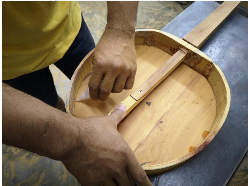
ภาพที่ 172 การใช้กาวร้อนหยอดแผ่นไม้ให้ติดกับตัวกะโหลก (ด้านใน) ที่มาภาพ : วิศรุต แซ่จู้ง
