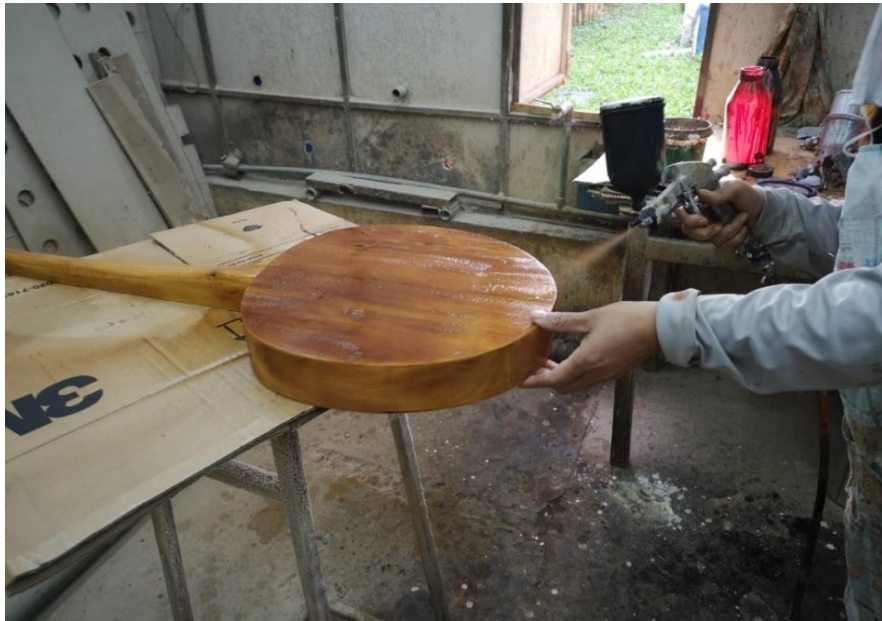
ภาพที่ 220 การพ่นเคลือบสีกะโหลก ที่มาภาพ : วิศรุต แซ่จ๋อง
