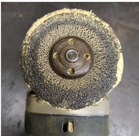
ภาพที่ 83 กระดาษทรายที่ใช้กับเครื่องเจียนลูกหมุน
