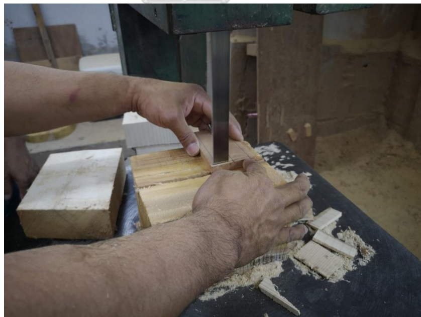
ภาพที่ 200 การเลื่อยด้วยใบเลื่อยไฟฟ้าขนาดเล็กตามแบบที่ร่างไว้ ที่มาภาพ : วิศรุต แซ่จ๋อง
