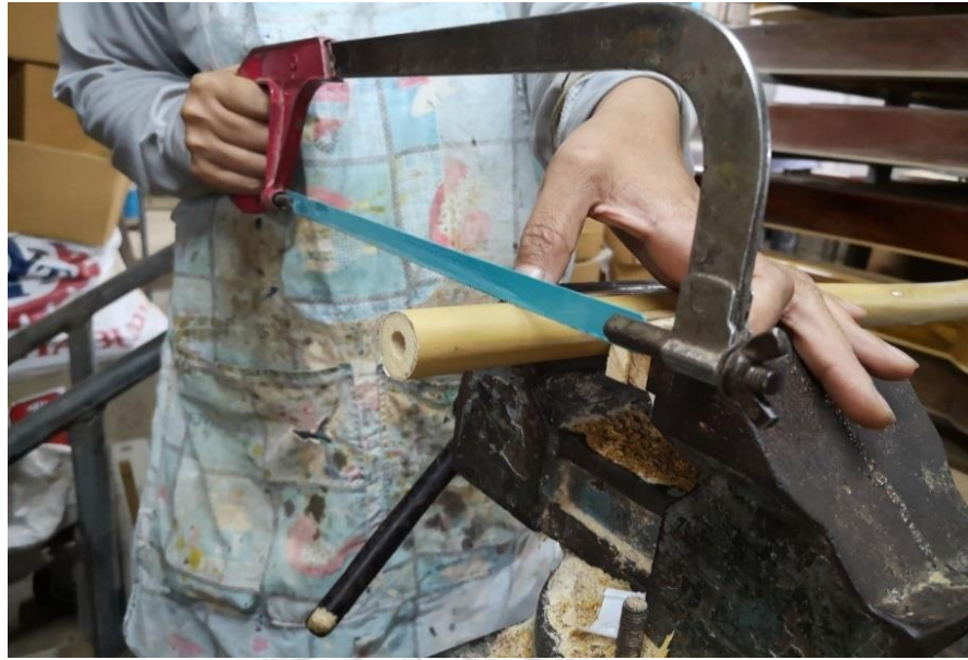
ภาพที่ 206 การนำไม้ไผ่รวกที่แก่เสี้ยนดำมาเลื่อยด้วยเลื่อยตัดเหล็ก ที่มาภาพ : วิศรุต แซ่จูง
