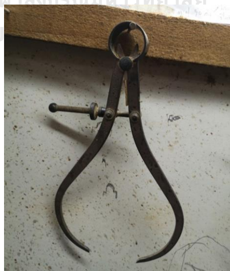
ภาพที่ 62 คาลิปเปอร์วัดนอก (เขาควย)
