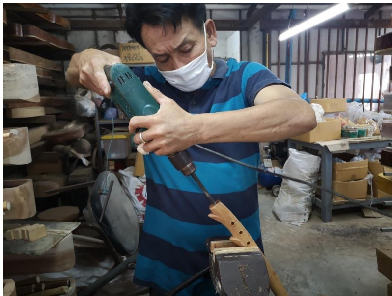
ภาพที่ 137 การใช้เครื่องสว่านไฟฟ้าเจาะรูสำหรับต่อแกนของโขน ที่มาภาพ : วิศรุต แซ่จูง
