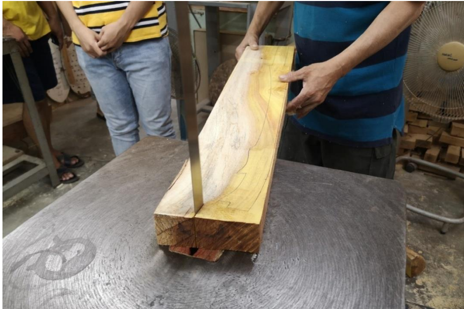
ภาพที่ 115 การเลื่อยไม้ตามแบบกระสวนของคันทวนที่ร่างไว้ ที่มาภาพ : วิศรุต แซ่จูง
