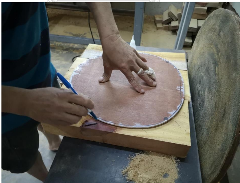
ภาพที่ 142 การใช้ปากกาวาดตามแบบกระสวนของกะโหลก
