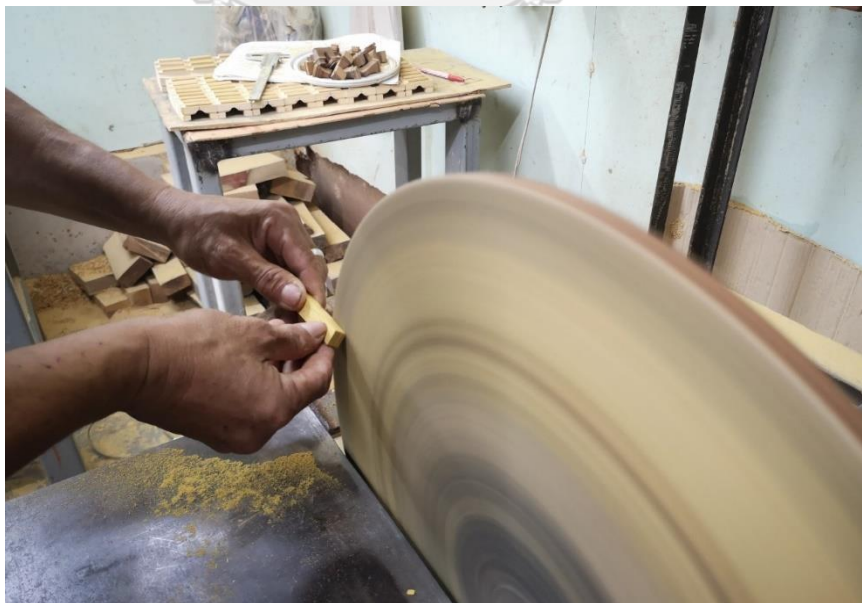
ภาพที่ 187 การใช้เครื่องกระดาษทรายงานขัดเดือยเพื่อให้รับกับรูของโขน ที่มาภาพ : วิศรุต แซ่จ๋อง
