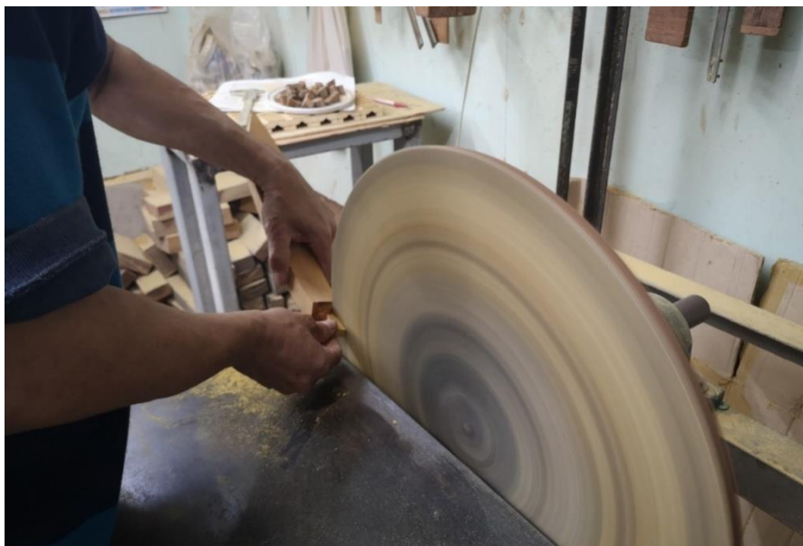
ภาพที่ 190 การใช้เครื่องกระดาษทรายจานขัดตกแต่งให้เรียบร้อย ที่มาภาพ : วิศรุต แซ่จูง
