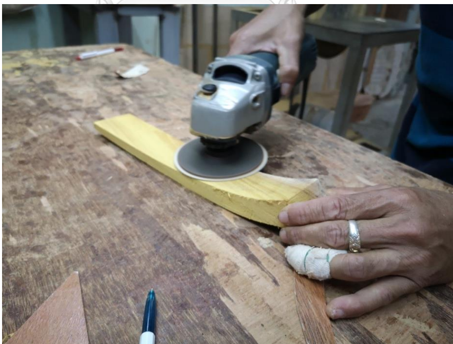
ภาพที่ 179 การใช้เครื่องเจียนลูกหมูปรับแต่งผิวเนื้อไม้ส่วนของโคนด้านข้าง ที่มาภาพ : วิศรุต แซ่จ๋อง
