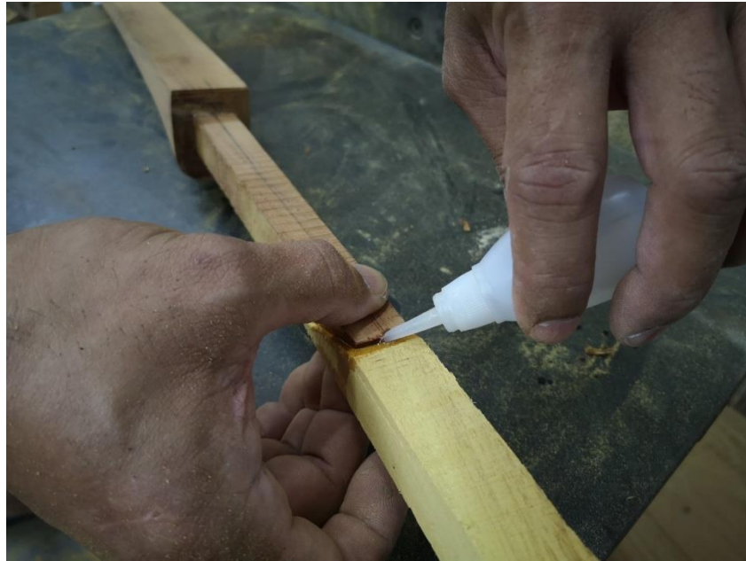
ภาพที่ 161 การใช้กาวร้อนหยอดประสานให้แกนทั้งสองติดกัน
