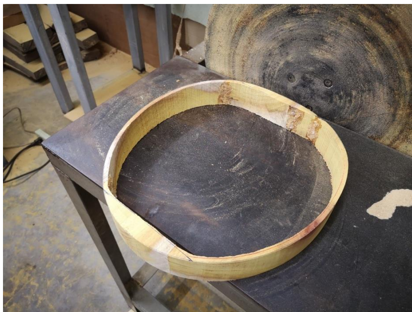
ภาพที่ 153 ส่วนของกะโหลกที่ขัดตกแต่งเสร็จเรียบร้อยแล้ว ที่มาภาพ : วิศรุต แซ่จูง
