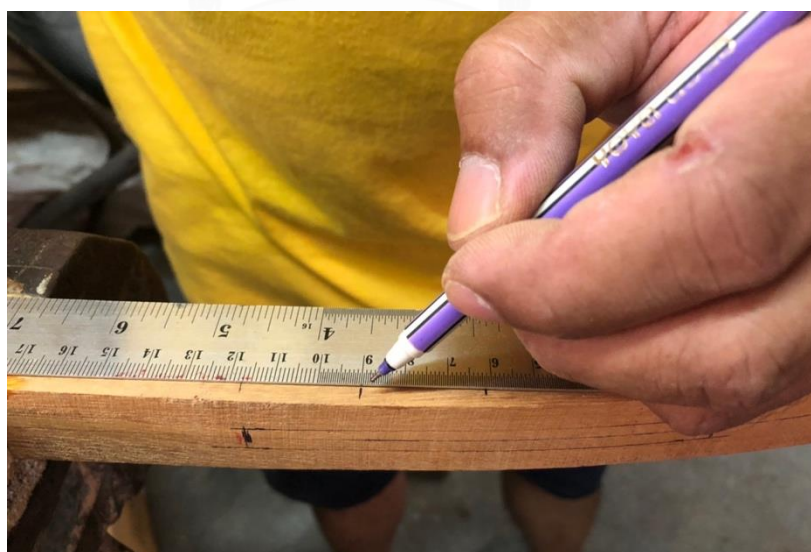
ภาพที่ 130 การใช้ปากการ่างให้ได้รูปทรงของรางไหม
