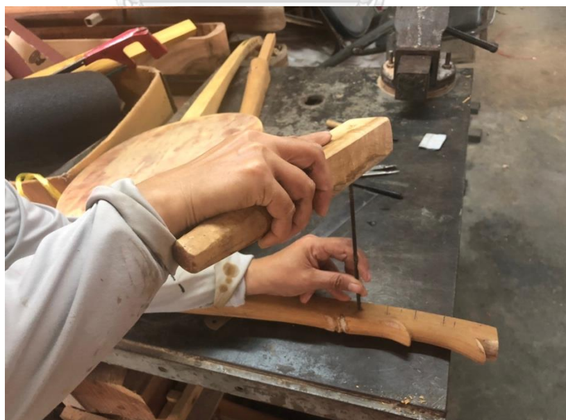
ภาพที่ 134 การใช้แท่งเหล็กตอกรูลูกบิดเพื่อเปิดทางสำหรับที่จะเจาะรู ที่มาภาพ : วิศรุต แซ่จูง
