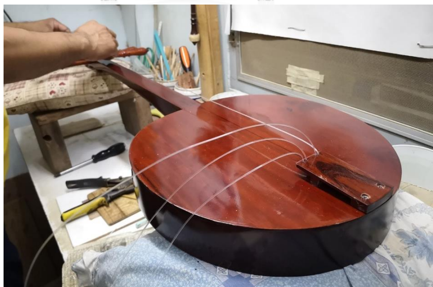
ภาพที่ 227 การใส่สายตัวกระจับปี
