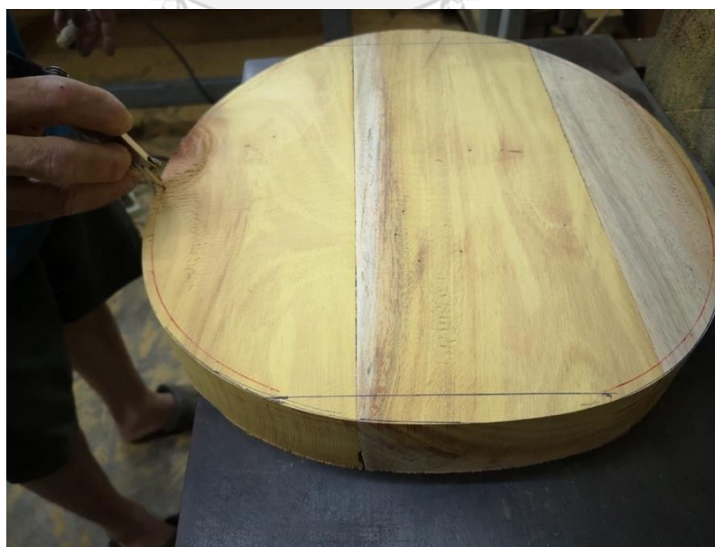
ภาพที่ 148 การใช้ดินสอร่างตามทรงกะโหลกให้เข้าไปข้างในจากขอบ
