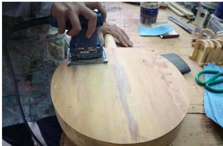
ภาพที่ 214 การใช้เครื่องกระดาษทรายสีเหลี่ยมผืนผ้าเก็บรายละเอียด ที่มาภาพ : วิศรุต แซ่จูง
