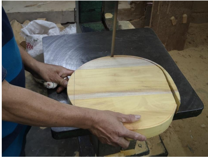
ภาพที่ 149 การใช้ใบเลื่อยไฟฟ้าเบอร์เล็กคว้านตามที่ร่างไว้ ที่มาภาพ : วิศรุต แซ่จูง
