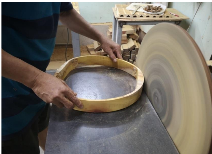
ภาพที่ 151 การเก็บรายละเอียดขัดผิวไม้ด้านนอกให้เรียบร้อยด้วยเครื่องกระดาษทรายจน ที่มาจากภาพ : วิศรุต แซ่จูง
