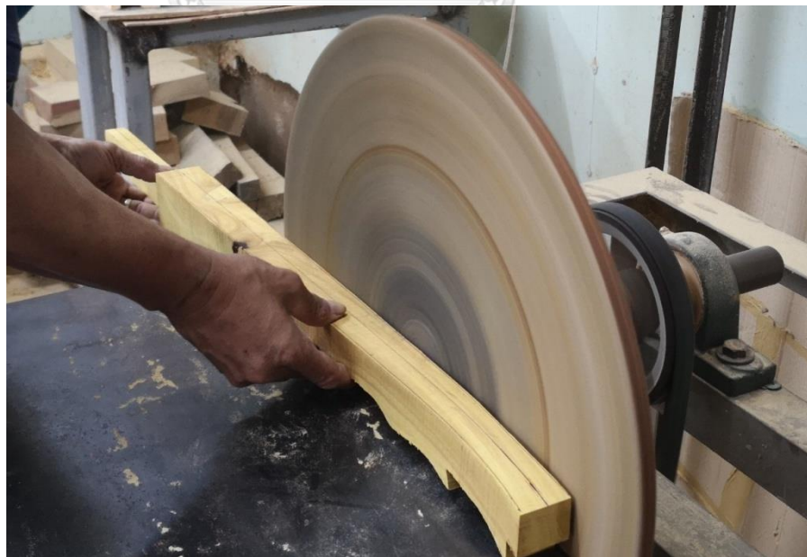
ภาพที่ 122 การใช้เครื่องกระดาษทรายงานขัดเก็บรายละเอียด
