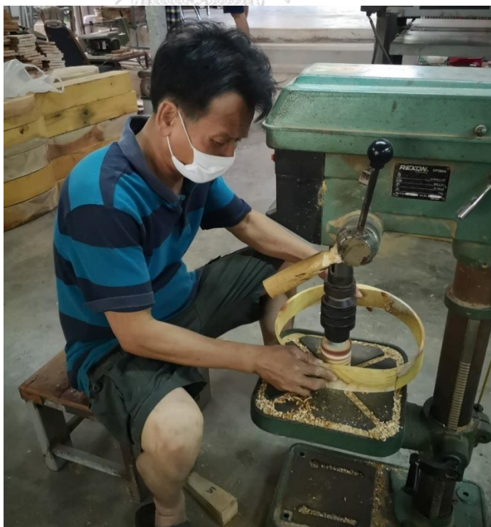
ภาพที่ 152 การใช้เครื่องสว่านไฟฟ้าแบบแท่น หัวเจียนแบบหัวกลมขัดตกแต่งผิวด้านในของกะโหลก ที่มาจากภาพ : วิศรุต แซ่จูง
