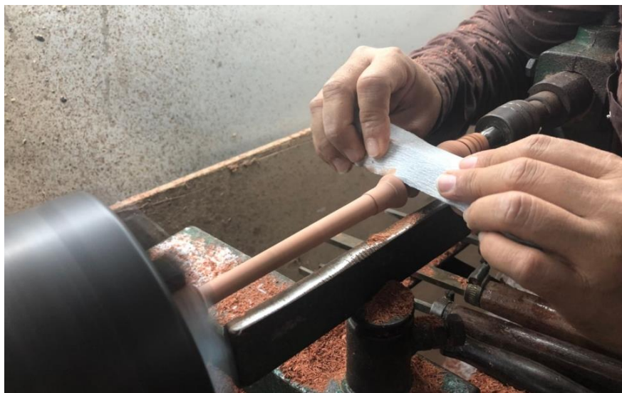
ภาพที่ 196 การใช้กระดาษทรายขัดลูกบิดและส่วนต่าง ๆ ให้เรียบ
