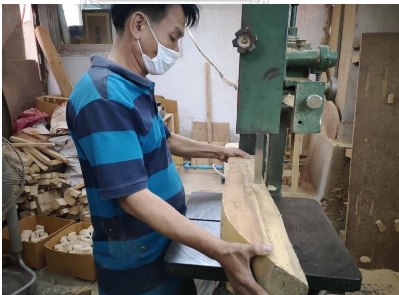
ภาพที่ 140 การนำไม้ขนุนมาตัดด้วยเครื่องเลื่อยไม้สายพาน ที่มาภาพ : วิศรุต แซ่จูง
