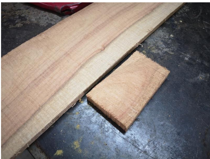
ภาพที่ 198 การนำไม้ประดู่มาตัดด้วยเลื่อยด้วยใบเลื่อยไฟฟ้าขนาดเล็กให้ได้รูปสี่เหลี่ยม ที่มาภาพ : วิศรุต แซ่จ้อย
