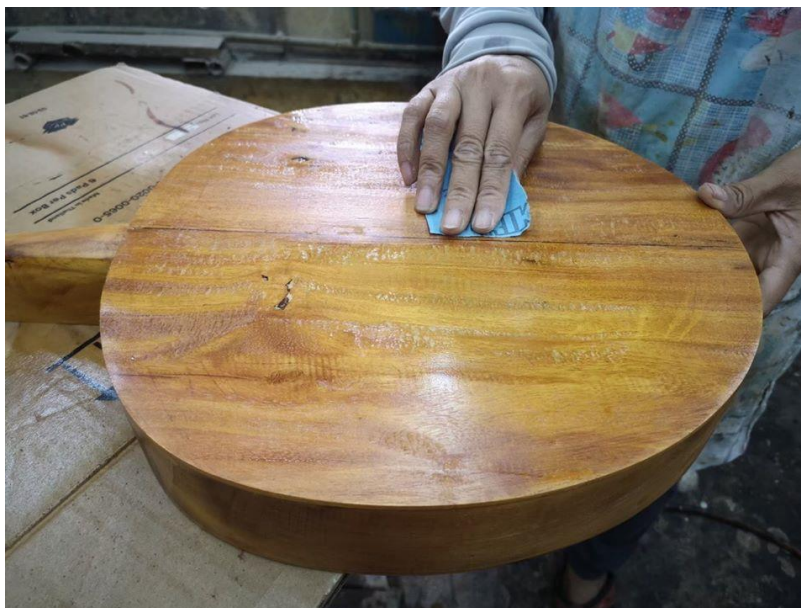
ภาพที่ 218 การใช้กระดาษทรายเบอร์ 240 มาขัดให้เรียบเนียน
