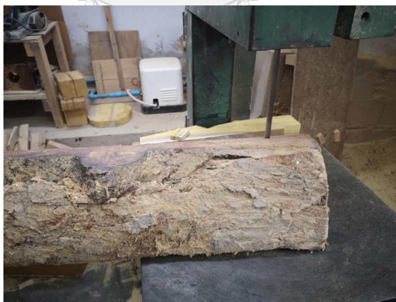
ภาพที่ 166 การใช้ใบเลื่อยไฟฟ้าเลื่อยไม้ให้เป็นแผ่น ที่มาภาพ : วิศรุต แซ่จูง
