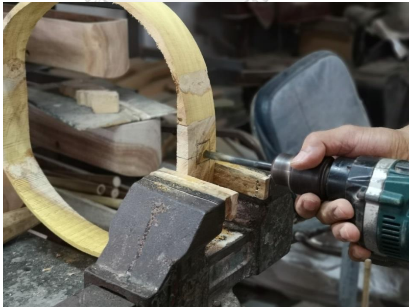
ภาพที่ 156 การใช้สว่านไฟฟ้าแบบพกพามาเจาะรูนำทาง ที่มาภาพ : วิศรุต แซ่จูง
