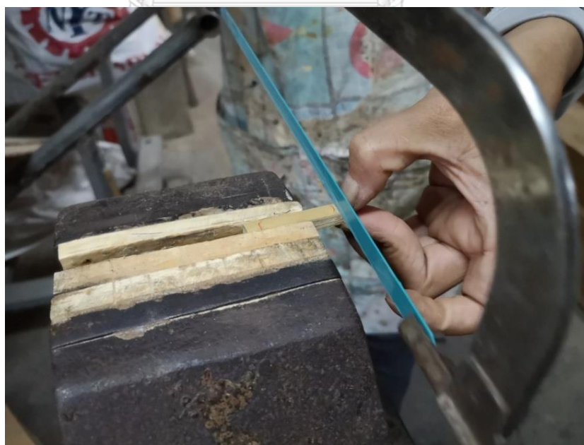
ภาพที่ 209 การเลื่อยด้วยเลื่อยตัดเหล็กเป็นชิ้น ๆ ให้ได้ขนาด
