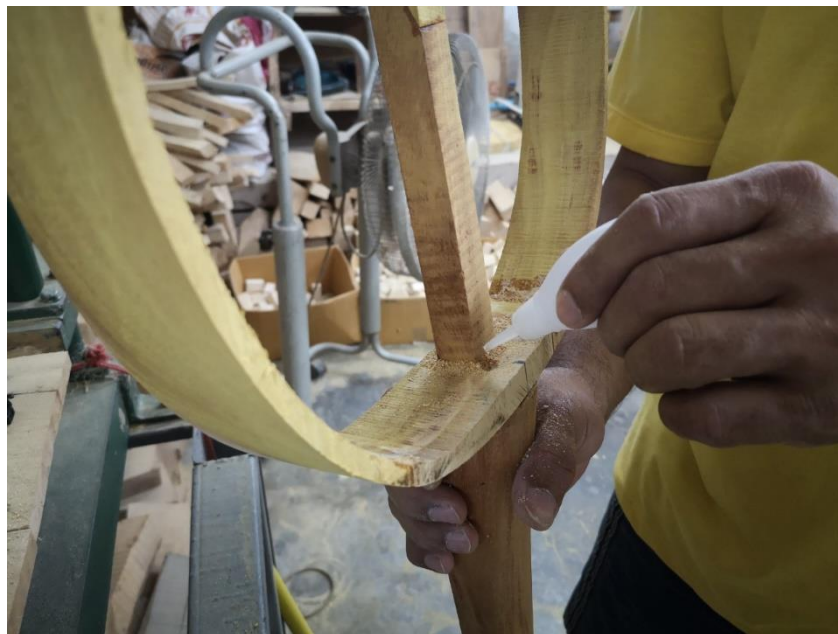
ภาพที่ 165 การใช้กาวร้อนหยอดประสานทั่ว ๆ ให้ระหว่างแกนกับตัวกะโหลกติดกันสนิท ที่มาภาพ : วิศรุต แซ่จูง
