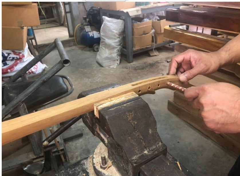
ภาพที่ 136 การใช้กระดาศทรายขัดตกแต่งข้างในรูลูกบิด ที่มาภาพ : วิศรุต แซ่จ๋อง
