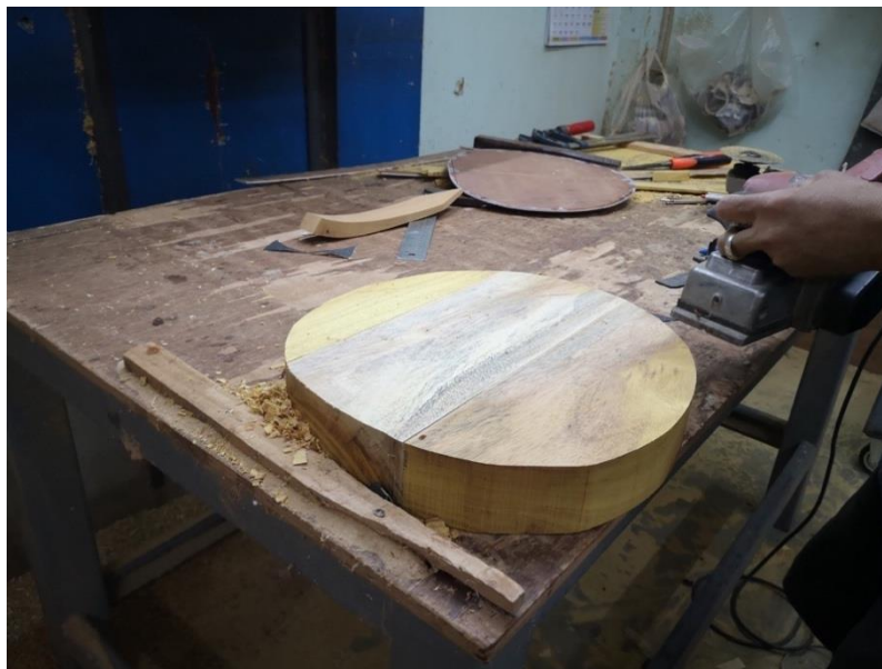
ภาพที่ 145 การใช้เครื่องไสไม้ปรับหน้าไม้สำหรับทำกะโหลก ที่มาภาพ : วิศรุต แซ่จูง
