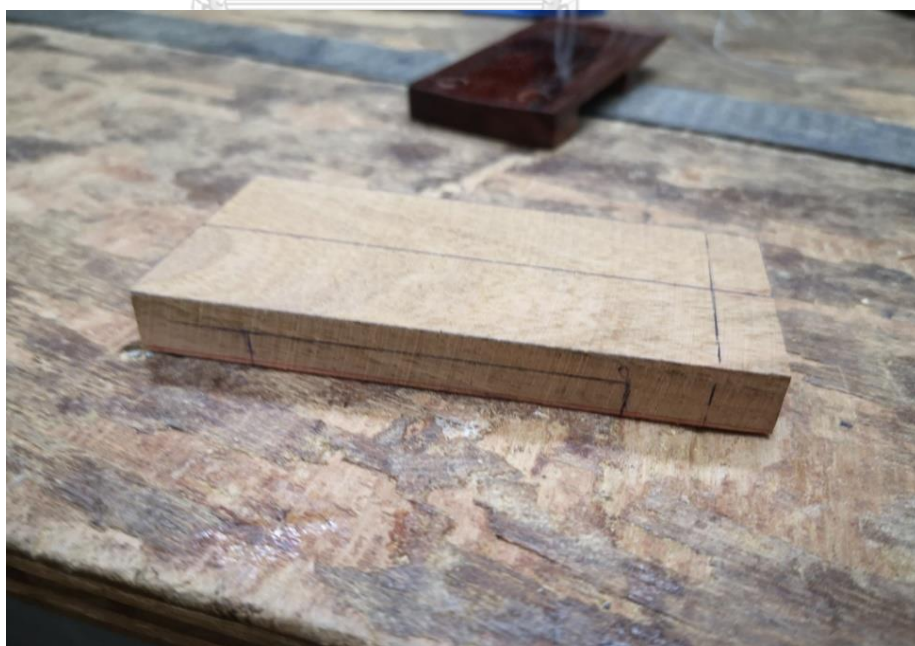
ภาพที่ 202 การวาดส่วนใต้ท้องหลักที่ต้องเลื่อยทิ้ง ที่มาภาพ : วิศรุต แซ่จูง
