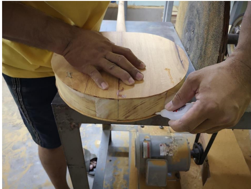
ภาพที่ 173 การใช้กาวร้อนหยอดแผ่นไม้ให้ติดกับตัวกะโหลก (ด้านนอก)
