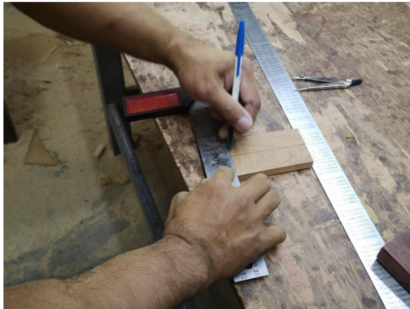
ภาพที่ 199 ภาพแสดงการวัดหาศูนย์กลางและร่างแบบด้วยปากกา ที่มาภาพ : วิศรุต แซ่จ๋อง
