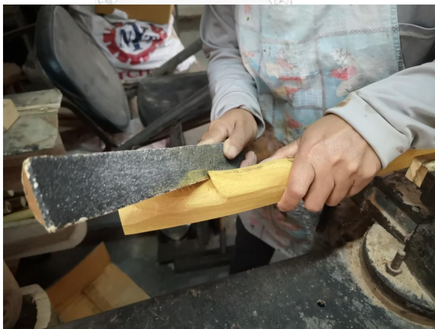
ภาพที่ 126 การใช้ตะไบกระดาษทรายขัดด้านหลังของคันทวน ที่มาภาพ : วิศรุต แซ่จุง
