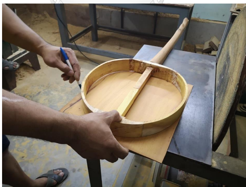
ภาพที่ 170 การนำแผ่นไม้มาวางทาบและใช้ปากการ่างตามแบบกะโหลก ที่มาภาพ : วิศรุต แซ่จ๋อง
