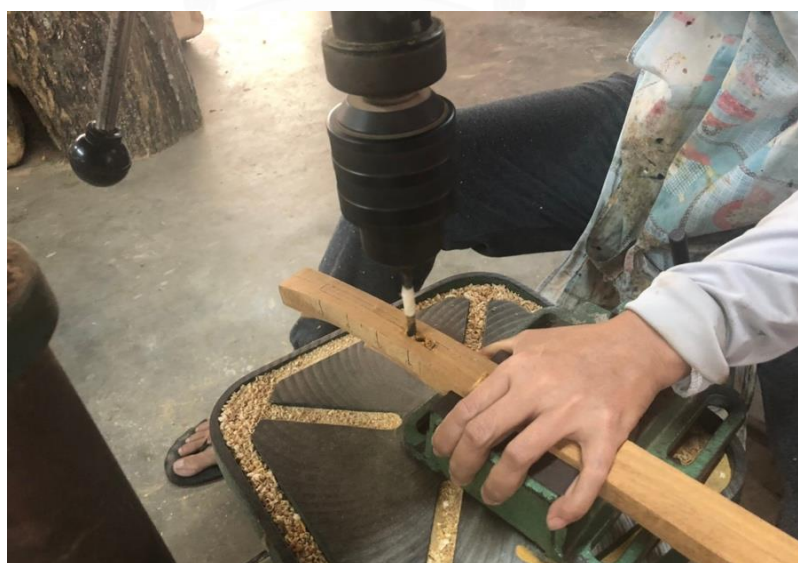
ภาพที่ 132 การใช้เครื่องสว่านไฟฟ้าแบบแท่น หัวสว่านไฟฟ้าเจาะนำเปิดทางรางไหม
