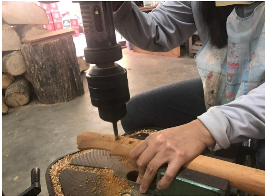
ภาพที่ 135 การใช้เครื่องสว่านไฟฟ้าแบบแท่น หัวสว่านไฟฟ้าเจาะตามรูลูกบิด ที่มาภาพ : วิศรุต แซ่จ๋อง
