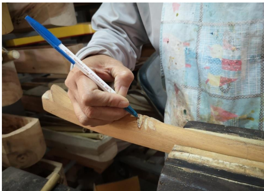
ภาพที่ 127 การใช้ปากกาทำร่องส่วนที่เป็นกาบเล็ก ที่มาภาพ : วิศรุต แซ่จ๋อง
