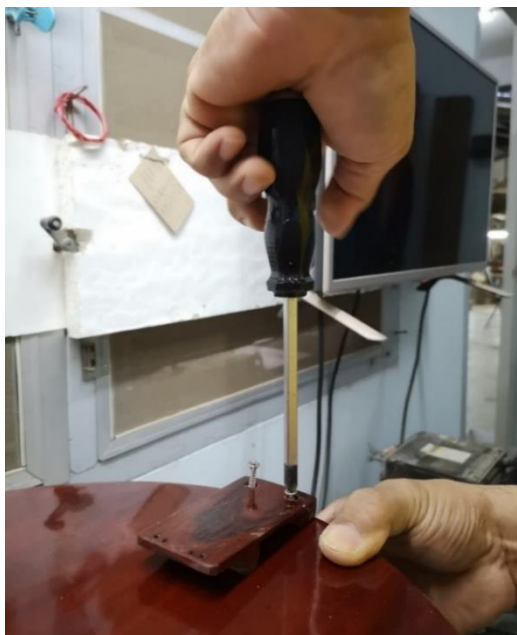
ภาพที่ 226 การใช้ไขควงขันน็อตให้หลักยึดกับกะโหลก
