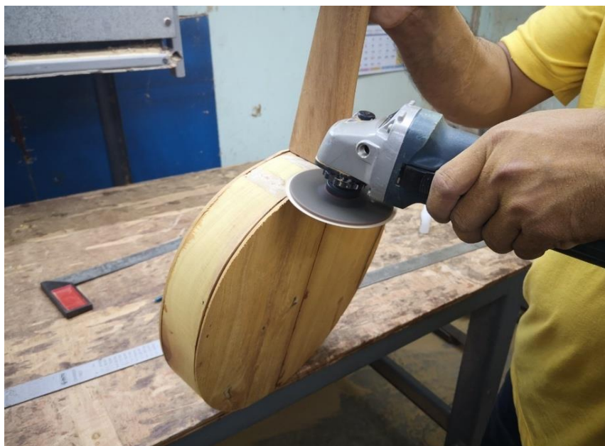
ภาพที่ 175 การใช้เครื่องเจียนลูกหมูขัดเก็บรายละเอียดของขอบตัวกะโหลก
