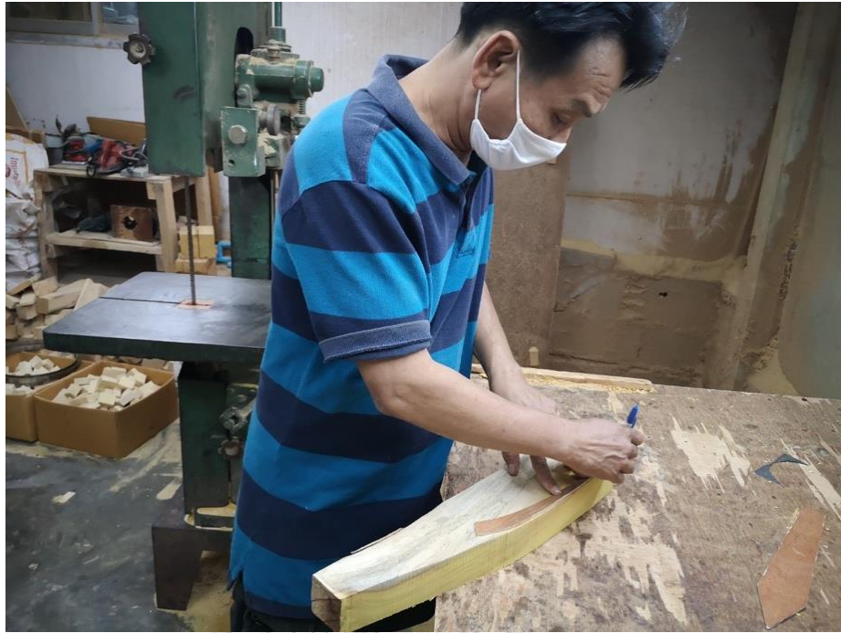
ภาพที่ 176 การใช้ปากการ่างแบบตามกระสวนของโหนด้านข้าง ที่มาภาพ : วิศรุต แซ่จ๋อง
