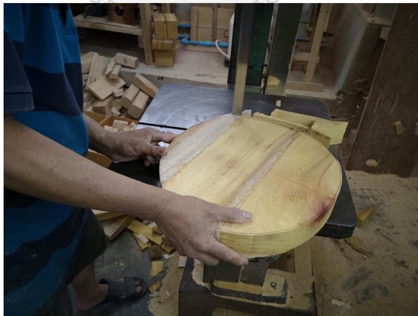
ภาพที่ 144 การใช้ใบเลื่อยไฟฟ้าเบอร์เล็กตัดตามกระสวยของกะโหลก ที่มาภาพ : วิศรุต แซ่จูง
