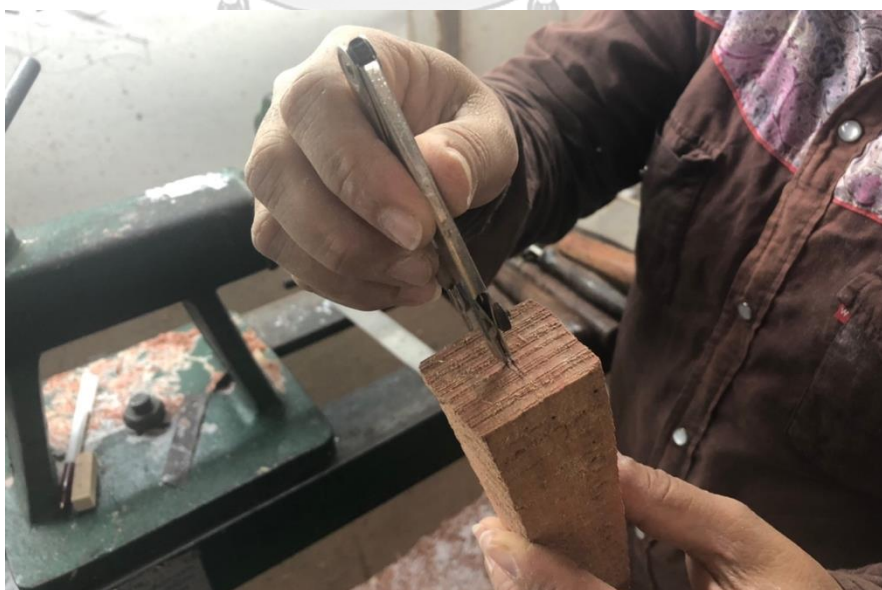
ภาพที่ 191 การใช้วงเวียนหาศูนย์กลางของลูกบิด ที่มาภาพ : วิศรุต แซ่จูง
