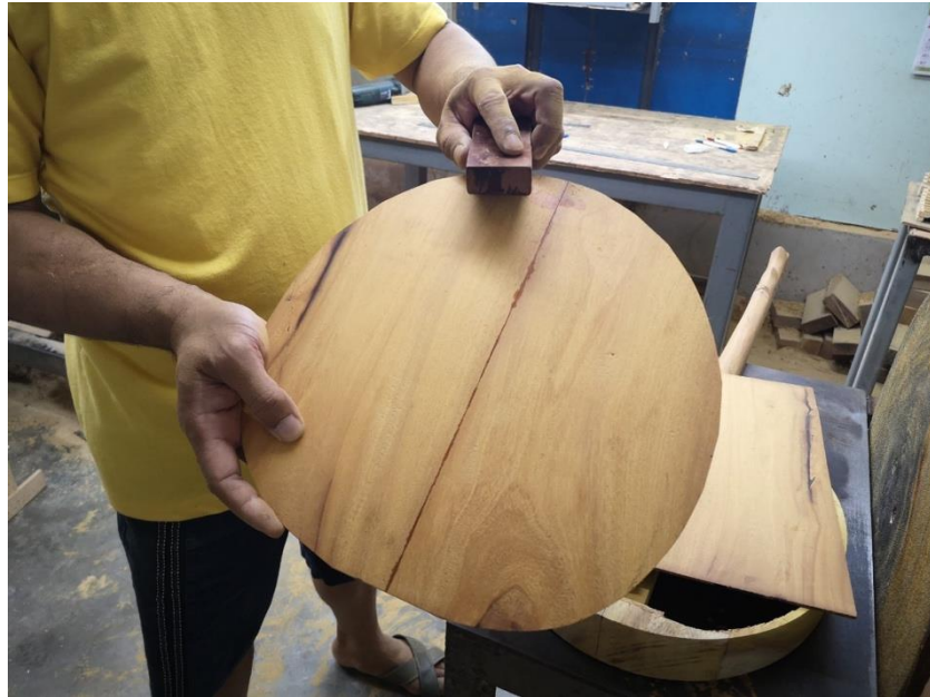
ภาพที่ 171 การใช้ตะไบกระดาษทรายขัดตกแต่งขอบของกะโหลก ที่มาภาพ : วิศรุต แซ่จู้ง
