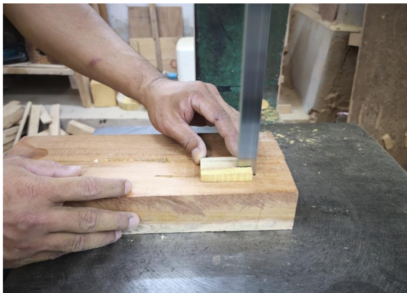
ภาพที่ 163 การใช้ใบเลื่อยไฟฟ้าตัดไม้ขนาดเล็ก 1 ชิ้น
