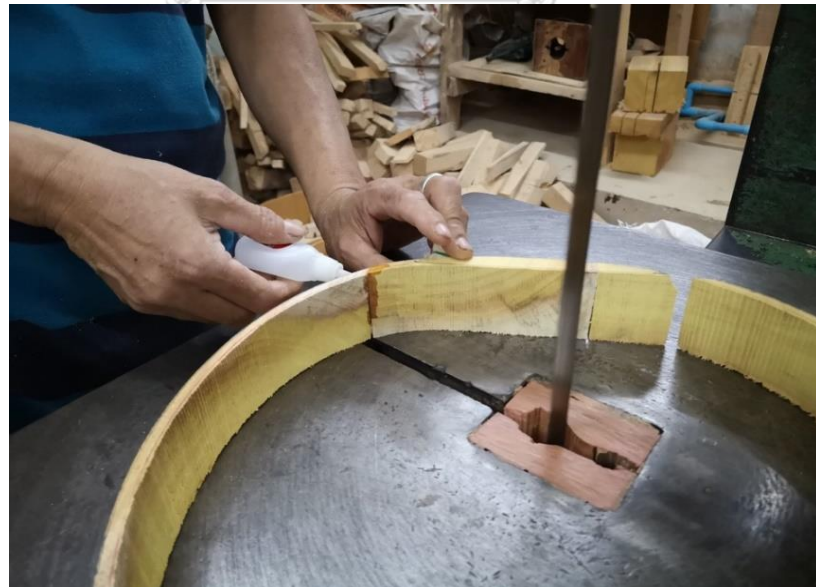
ภาพที่ 150 การใช้กาวยร้อนหยอดติดกันบริเวณรอยต่อของไม้ส่วนบนของกะโหลก ที่มาภาพ : วิศรุต แซ่จูง
