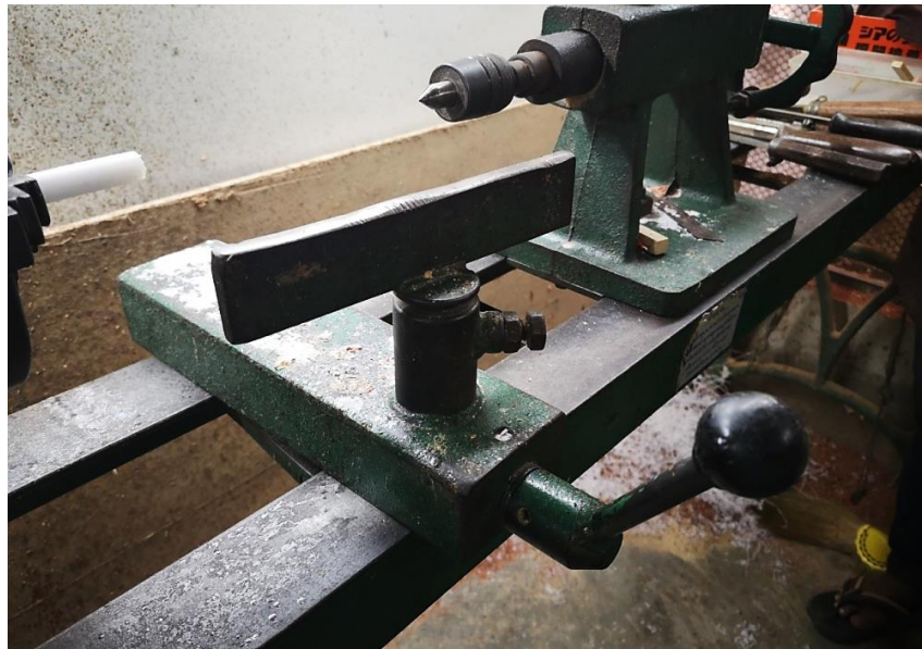
ภาพที่ 89 แท่นมีดกลึง ที่มาภาพ : วิศรุต แซ่จู้ง
