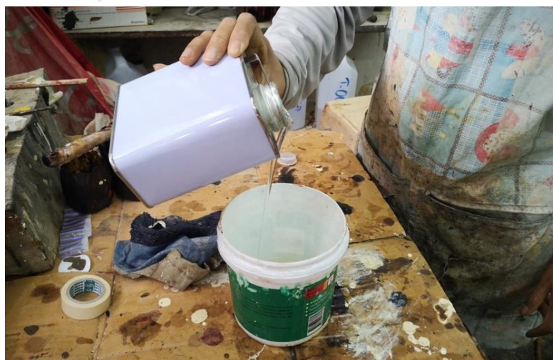
ภาพที่ 215 การเทสีโพลียูรีเทนสีใส ตัวเร่งแข็งยูรีเทน และทินเนอร์ยูรีเทนมาผสมเข้ากัน ที่มาภาพ : วิศรุต แซ่จูง
