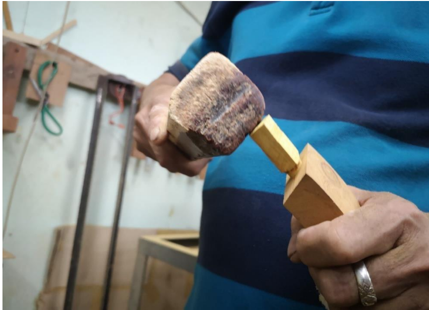
ภาพที่ 188 การใช้ค้อนไม้ตอกเดือยเข้ารูให้แน่นสนิทกับตัวโขน ที่มาภาพ : วิศรุต แซ่จูง
