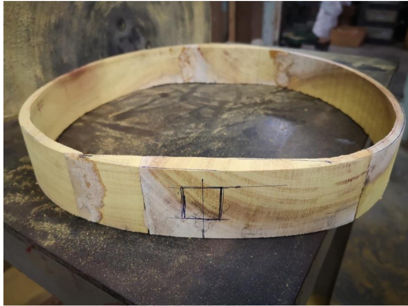
ภาพที่ 155 แบบร่างรูต่อกับแกนคันทวน ที่มาภาพ : วิศรุต แซ่จูง
