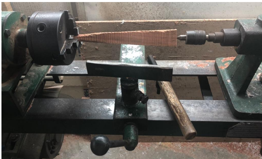
ภาพที่ 192 การนำไม้มาใส่เข้ากับแท่นกลึง ที่มาภาพ : วิศรุต แซ่จุง
