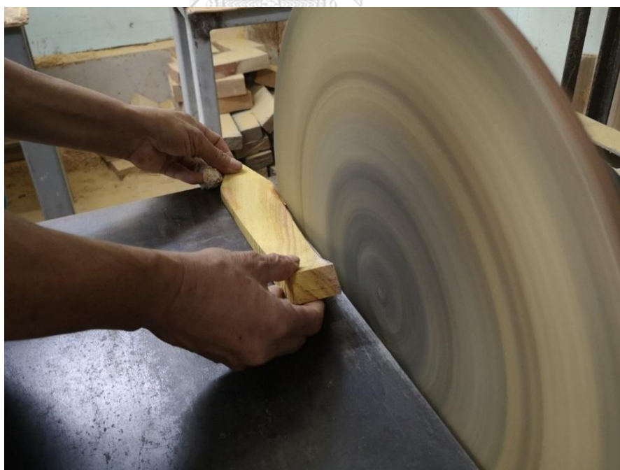
ภาพที่ 183 การใช้เครื่องกระตาศทรายงานขัดตกแต่งเก็บรายละเอียดของโขน ที่มาภาพ : วิศรุต แซ่จูง
