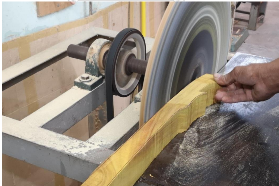
ภาพที่ 116 การขัดปรับพื้นผิวไม้ของคันทวนด้วยเครื่องกระดาษทรายจาน ที่มาภาพ : วิศรุต แซ่จูง
