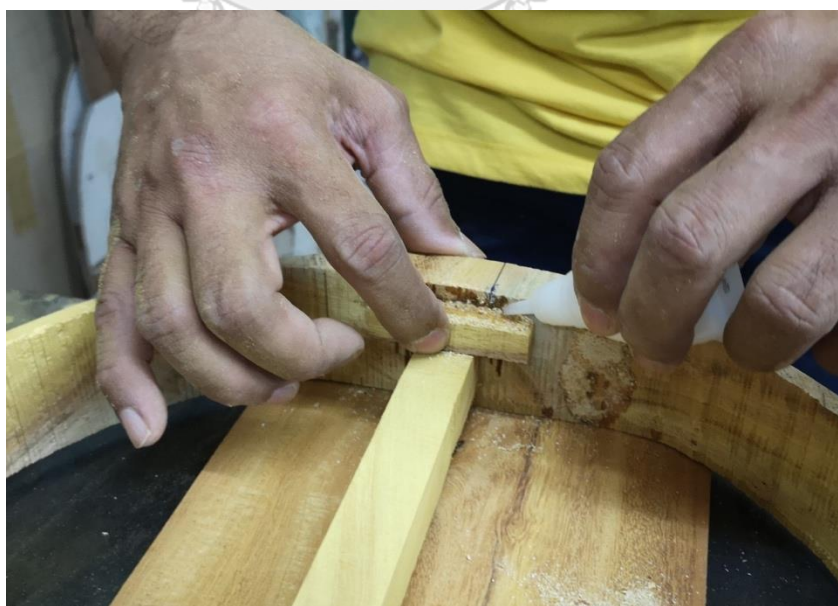
ภาพที่ 164 การใช้ซี่เลื่อยกับกาวร้อนเป็นตัวประสานไม้ชิ้นเล็กกับแกนและกะโหลกให้ติดกัน
