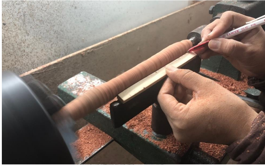
ภาพที่ 194 การใช้ปากกาขีดทำสัญลักษณ์ตามไม้วัดระยะกระสวน ที่มาภาพ : วิศรุต แซ่จูง
