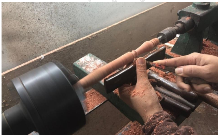
ภาพที่ 195 การกลึงขึ้นรูปลูกแก้วด้วยมีดหน้าตรงเล็ก ที่มาภาพ : วิศรุต แซ่จูง
