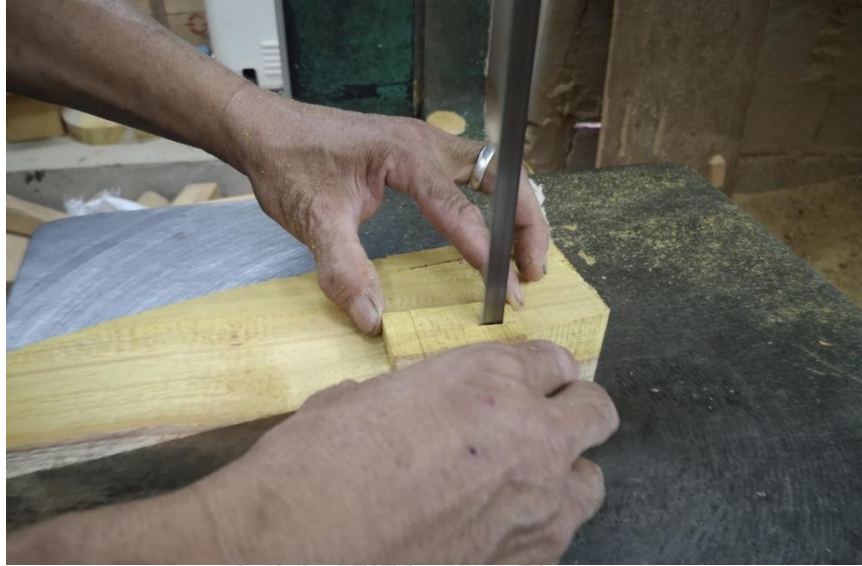
ภาพที่ 186 การใช้ใบเลื่อยไฟฟ้าตัดไม้ชิ้นขนาดเล็กสำหรับเป็นเดือยต่อคันทวน ที่มาภาพ : วิศรุต แซ่จ๋อง
