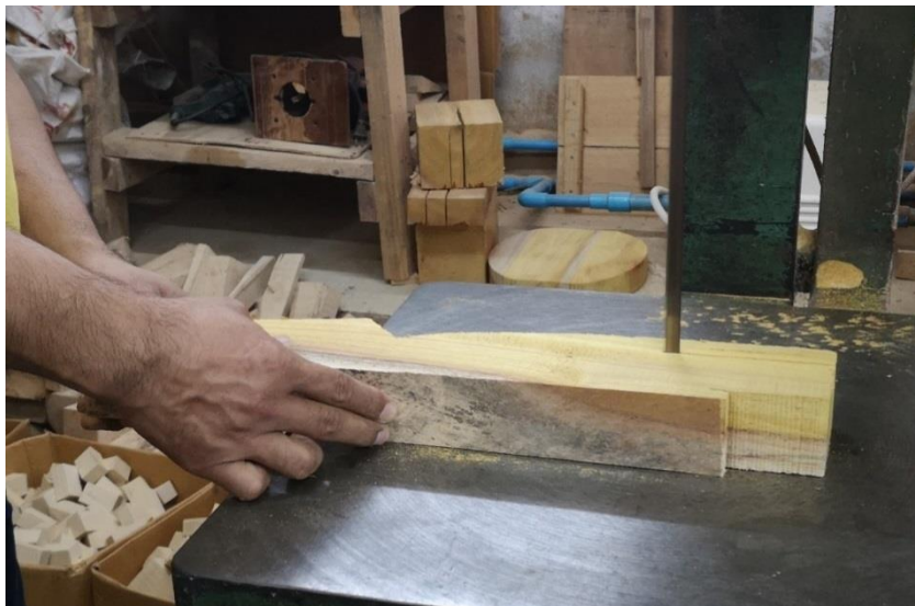
ภาพที่ 159 การใช้ใบเลื่อยไฟฟ้าเบอร์เล็กมาตัดไม้ขนุนสำหรับเป็นแกนกลางของคันทวน
