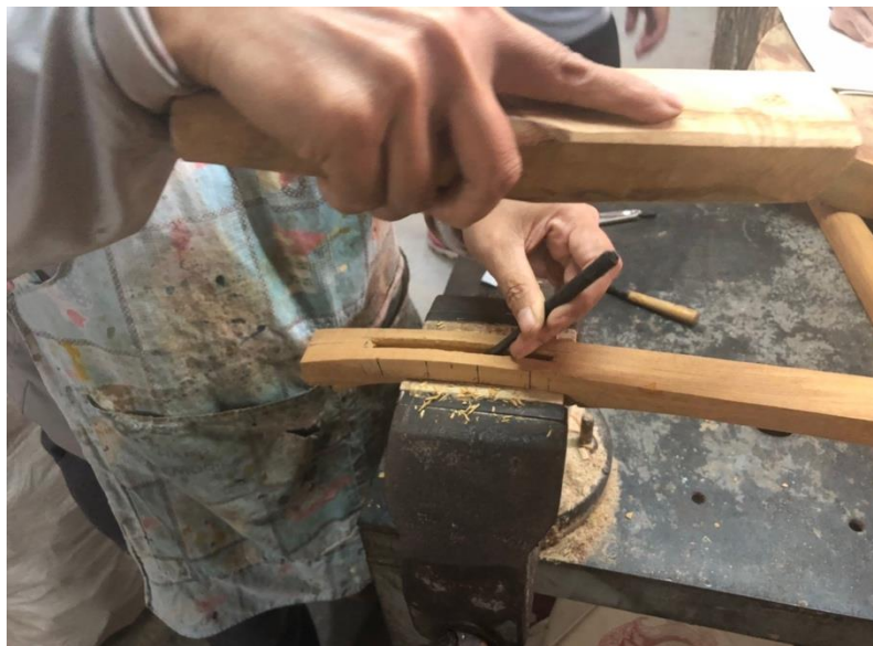
ภาพที่ 133 การใช้สิ่วเซาะเนื้อไม้ ให้ได้รูปทรงรางใหม่ตามที่ร่างไว้ ที่มาภาพ : วิศรุต แซ่จูง
