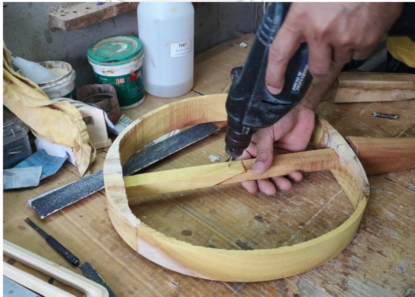
ภาพที่ 162 การใช้สว่านไฟฟ้าดอกเล็กเจาะรูยึดแกนระหว่างแกนบนกับแกนล่าง
