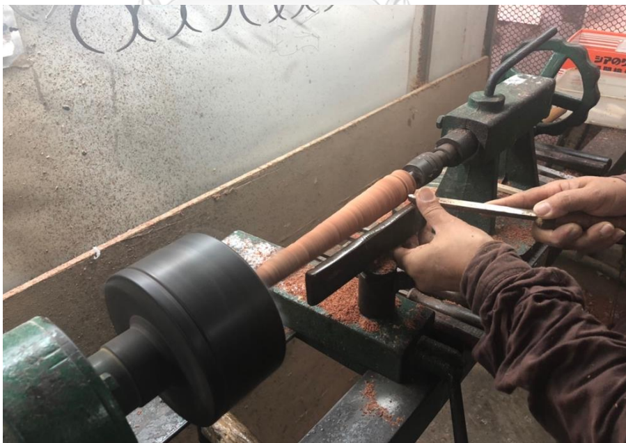
ภาพที่ 193 การใช้มีดหน้าโค้งใหญ่กลึงลบเหลี่ยม ที่มาภาพ : วิศรุต แซ่จุง
