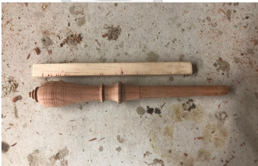
ภาพที่ 197 ลูกบิดที่ทำเสร็จแล้วกับไม้วัดระยะกระสวน
