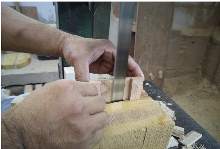
ภาพที่ 203 การนำหลักมาเลื่อยด้วยใบเลื่อยไฟฟ้าขนาดเล็กตามที่ร่างไว้ ที่มาภาพ : วิศรุต แซ่จูง
