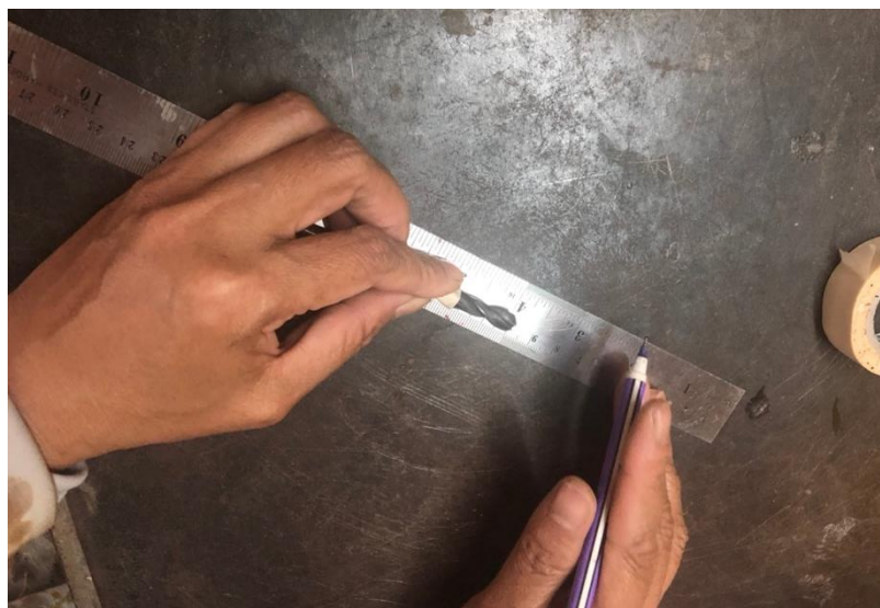
ภาพที่ 131 ภาพแสดงการวัดขนาดความลึกของหัวสว่าน
