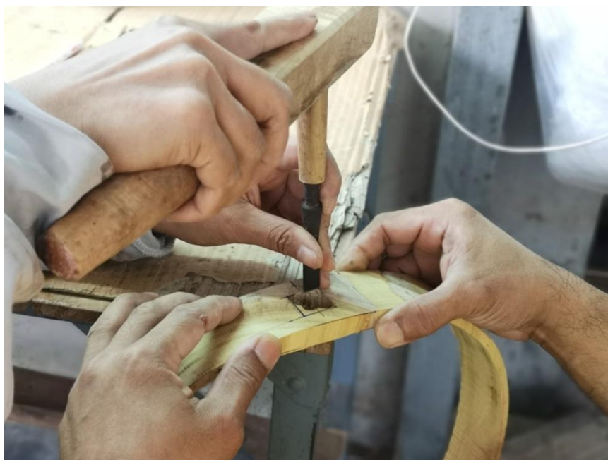
ภาพที่ 157 การใช้ส่วเซาะรูไม้ตามที่ร่างไว้ ที่มาภาพ : วิศรุต แซ่จูง
