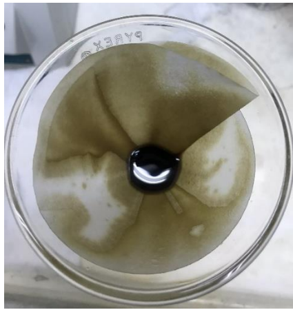
รูปที่ 3.2 การกรองน้ำมันประเภท Validated oil ด้วยกระดาษกรองเบอร์ 1
