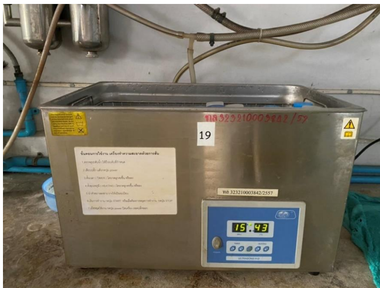
ภาพที่ 3.5. เครื่อง sonication ที่ใช้ทำให้ไมโครพลาสติกหลุดออกจากแผ่นกรอง
