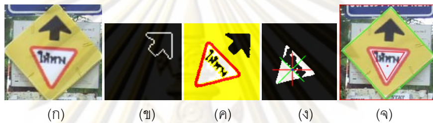
รูปที่ 3.29 (ก) บริเวณที่สนใจที่มีป้ายเตือนรหัส ต.55 (ข) โพรไฟล์ขอบ (ค) โพรไฟล์สี (ง) วัตถุสีขาว ที่ตรวจหาได้ (จ) ผลลัพธ์ของการจำแนก
