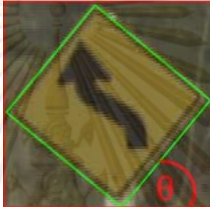
รูปที่ 3.16 มุมที่รูปสี่เหลี่ยมมุมฉากปิดล้อมที่มีพื้นที่น้อยที่สุดทำกับขอบล่างสุดของบริเวณที่สนใจ
