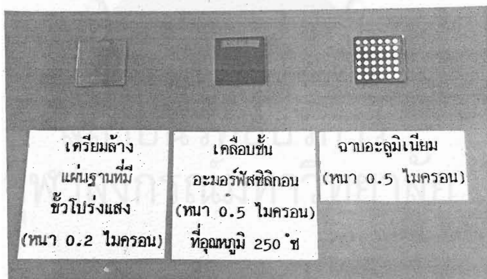
รูปที่ 3.4 ภาพถ่ายเซลล์แสงอาทิตย์ที่ผลิตได้ในขั้นตอนต่าง ๆ
