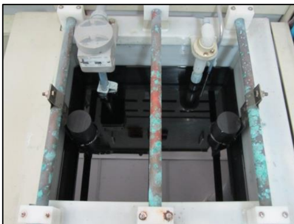
ภาพที่ 3.2 บ่อชุบสำหรับชุบโครเมียมด้วยไฟฟ้ากระแสตรง โดยใช้แอโนดแบบถาวร
