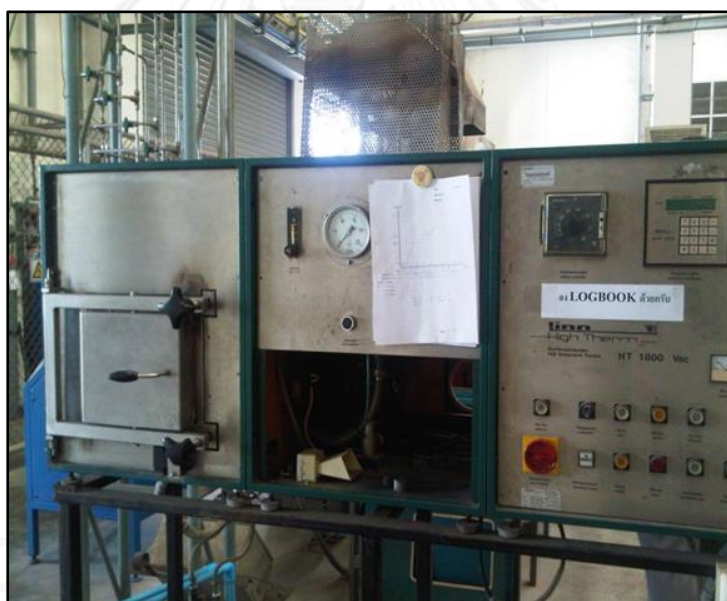
ภาพที่ 3.3 เตาไฮโดรเจนใช้สำหรับการสูญเสียคาร์บอนที่ผิว
