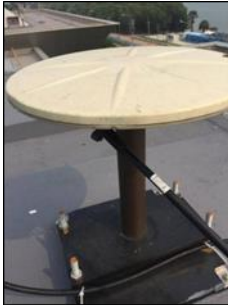
รูปที่ 3.2 เสาอากาศยี่ห้อ Trimble รุ่น Zephyr Geodetic
