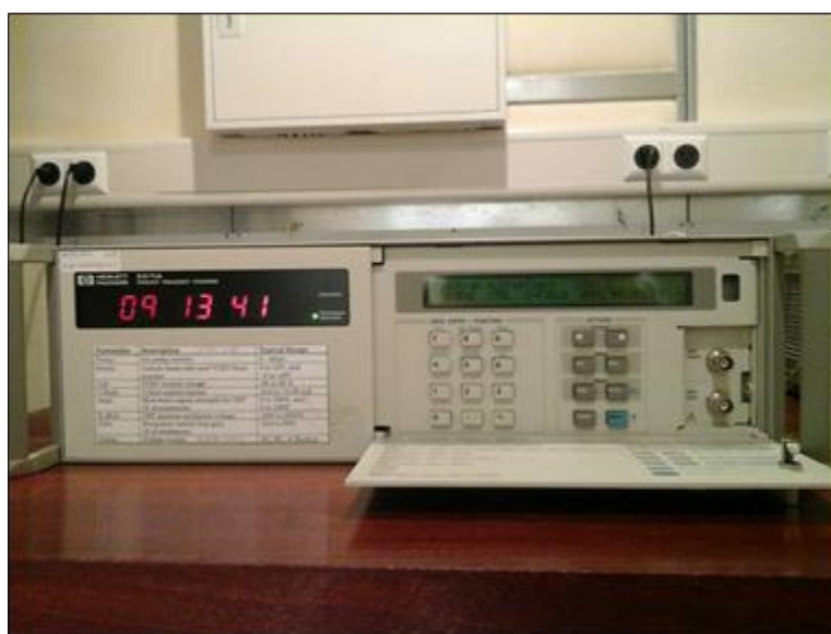
รูปที่ 2.4 นาฬิกาอะตอมแบบซีเซียม (Caesium Atomic Clock) รุ่น 5017A ณ สถาบันมาตรวิทยาแห่งชาติ
