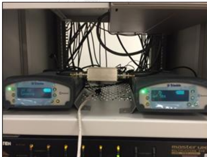
รูปที่ 3.3 การติดตั้งเครื่องรับสัญญาณ ยี่ห้อ Trimble รุ่น Net R9 จำนวน 2 เครื่อง พร้อมทั้งต่อ Antenna Splitter
