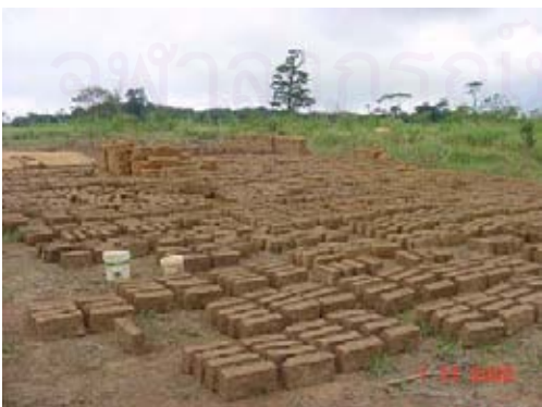
ภาพที่ 4-15 แสดงบริเวณที่ทำการผสมทำอิฐดิน ที่มา : บันทึกเมื่อ 1 พฤศจิกายน 2545
