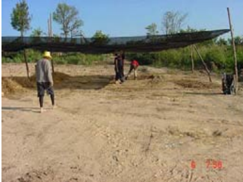
ภาพที่ 4-29 แสดงการเตรียมพื้นที่การตากอิฐ ที่มา : บันทึกเมื่อ 6 พฤศจิกายน 2545
