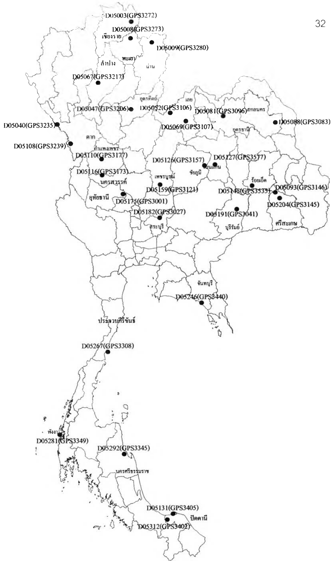
ภาพที่ 4.1 แสดงตำแหน่งของหมุดหลักฐานที่มีการรังวัดร่วมกันระหว่างกรมแผนที่ทหารกับกรมที่ดิน
