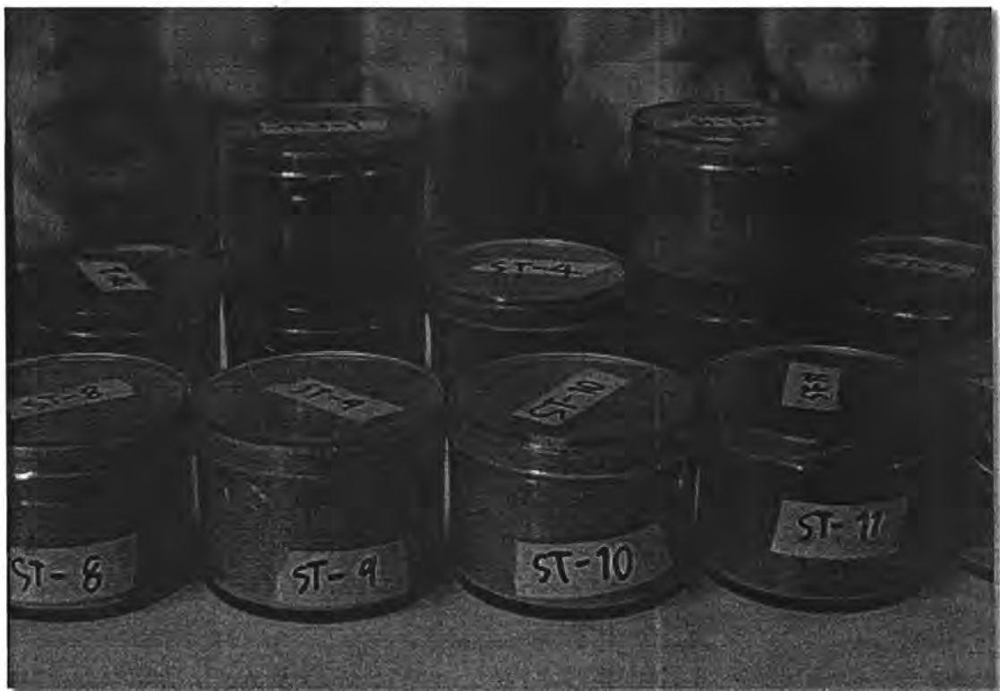
รูป 3.2 รูปแสดงการเตรียมตัวอย่างเพื่อนำไปวิเคราะห์อัตราการแผ่รังสีต่อปี
