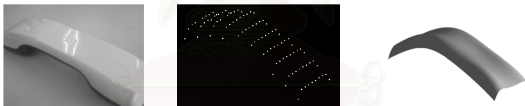
รูปที่ 6.55 แสดงพื้นผิวหูโทรศัพท์ ผลของการวัดและการสร้างพื้นผิว
